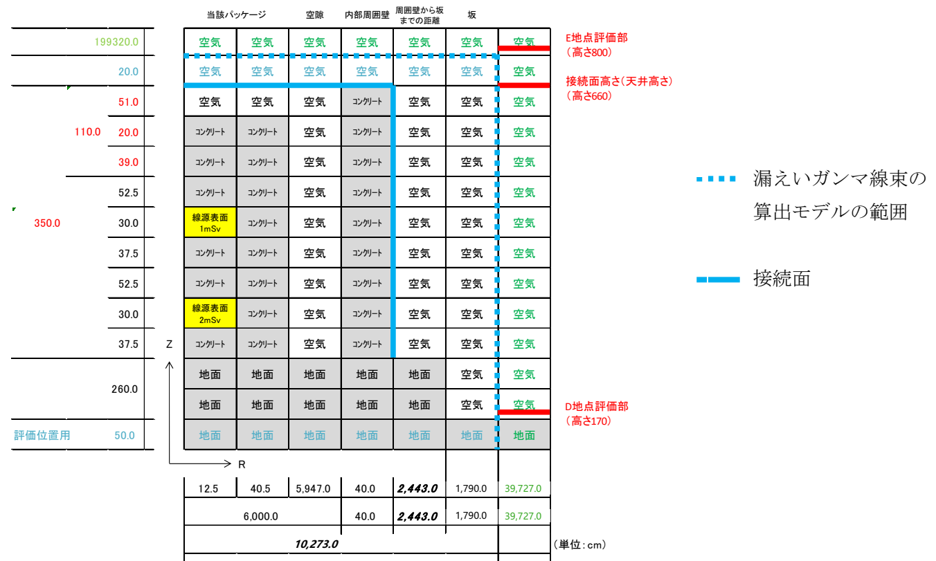
図 11 ブロック型廃棄物パッケージB-III型の評価モデル (廃棄物1組のみ)
