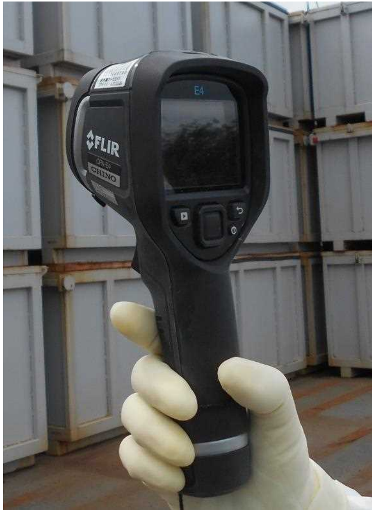
サーモグラフィ
