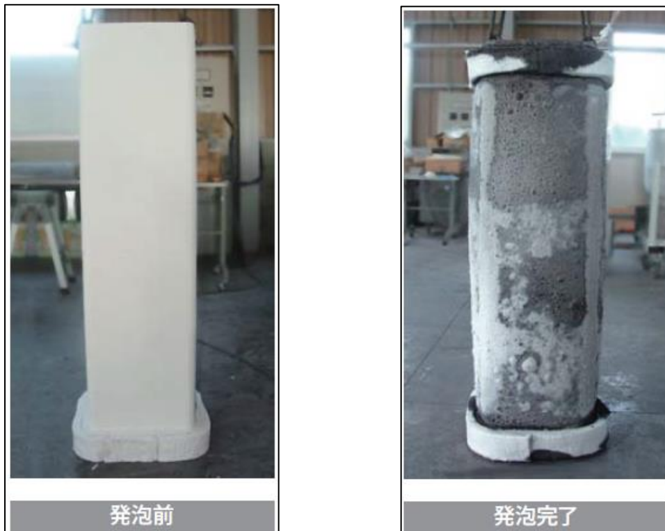
第 5 - 12 図 大臣認定試験の試験体の発泡前後の様子
