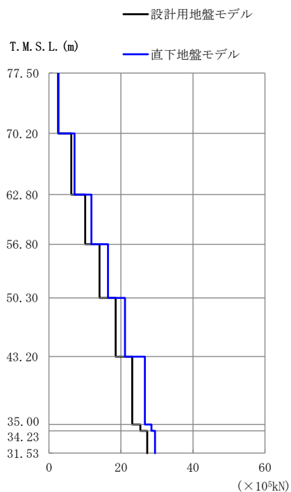
第 2.4.2.1-10 図 最大応答せん断力 (NS 方向 1.2×S s -C1 (NSEW))
