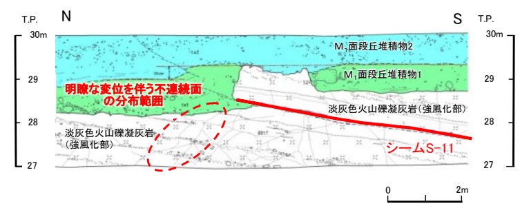
Ts-7トレンチ東側法面: 変状が認められる シーム及び変位を伴う不連続面が明瞭な弱面として分布する (補足説明資料P.8-4, 8-5参照)
