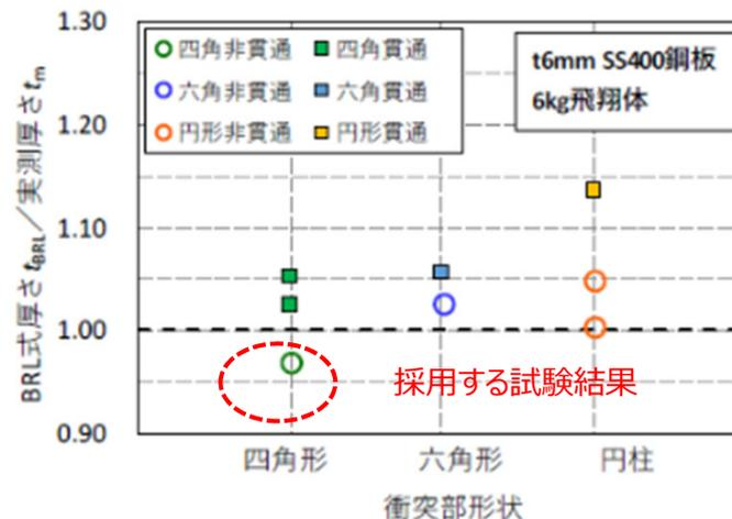
図 貫通試験の結果（電中研報告O19003）
