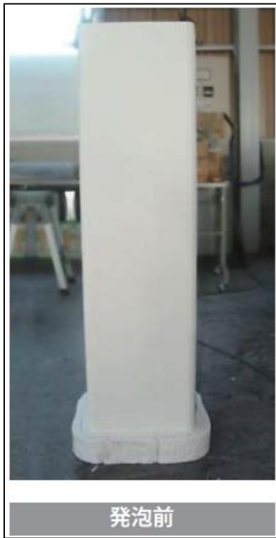
第 5 - 12 図 大臣認定試験の試験体の発泡前後の様子
