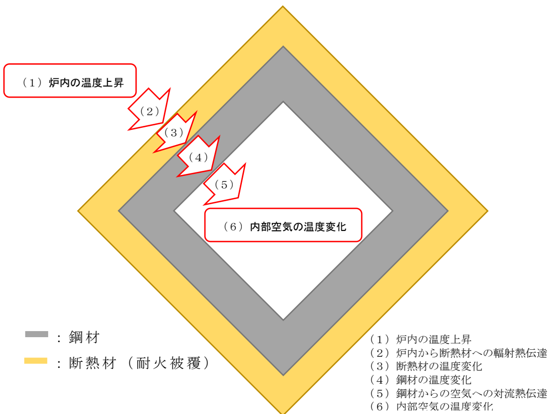
第 1 図 鋼材温度評価の概略図
