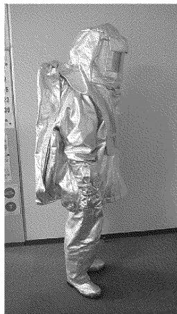
第 7 図 耐熱服（空気呼吸器の上から耐熱服を着用した状態）
