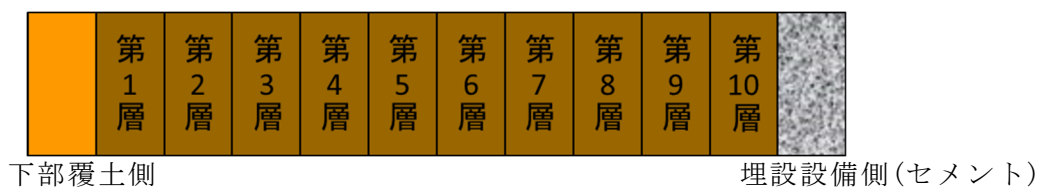
第 14 図 難透水性覆土の層の定義
