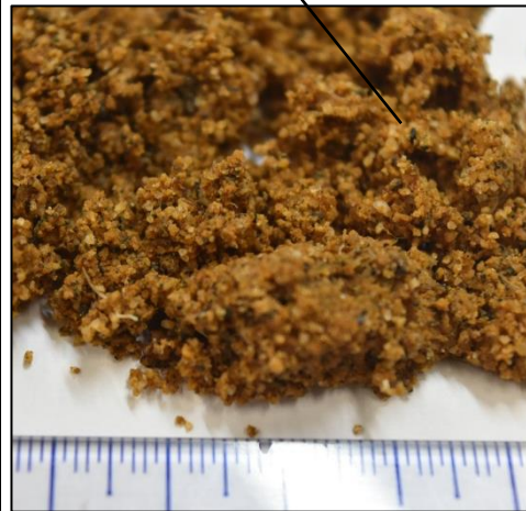
当該地点で採取した三瓶浮布テフラの接写写真 φ 1mm以下の角閃石を含む。
