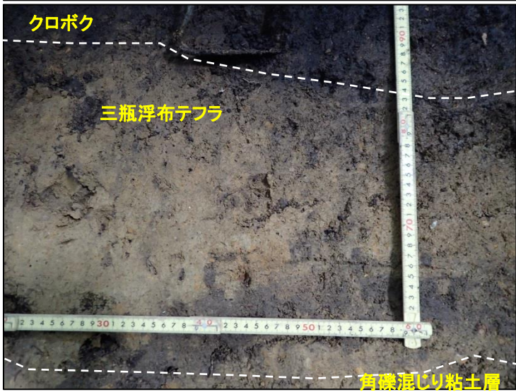
当該地点で採取した三瓶浮布テフラの接写写真 \phi 1mm以下の角閃石を含む。
