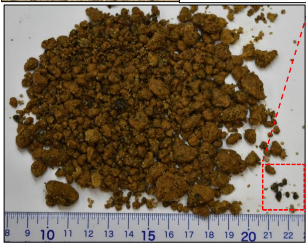
当該地点で採取した三瓶浮布テフラの接写写真 φ 3mm以下の角閃石を含む。
