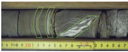
試料採取位置例 (No. 124 ボーリングコア) (GL-40.10~40.20m)
