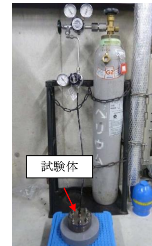
第 41 図 He 気密確認試験状況
