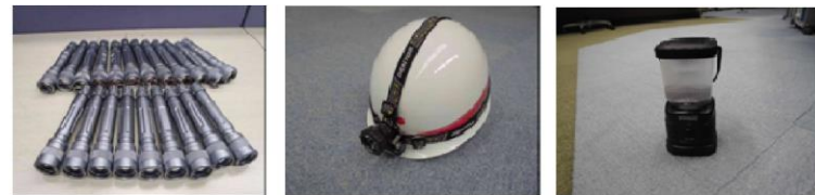
中央制御室における照明の確保 (例)
