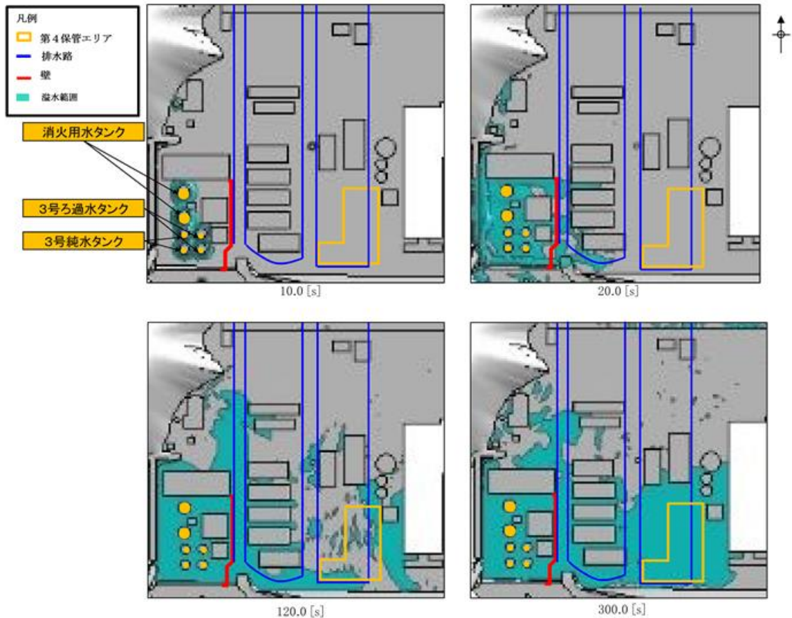
第13図 第4保管エリア近傍の溢水の伝播挙動
