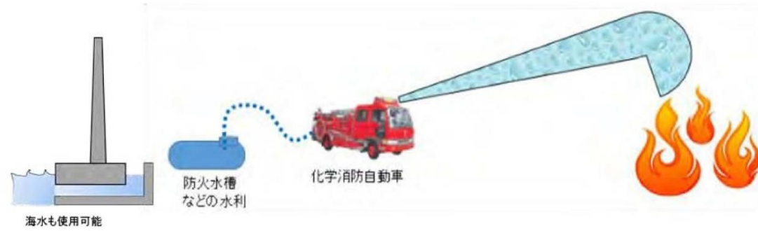
図 8-2 化学消防自動車による泡消火
