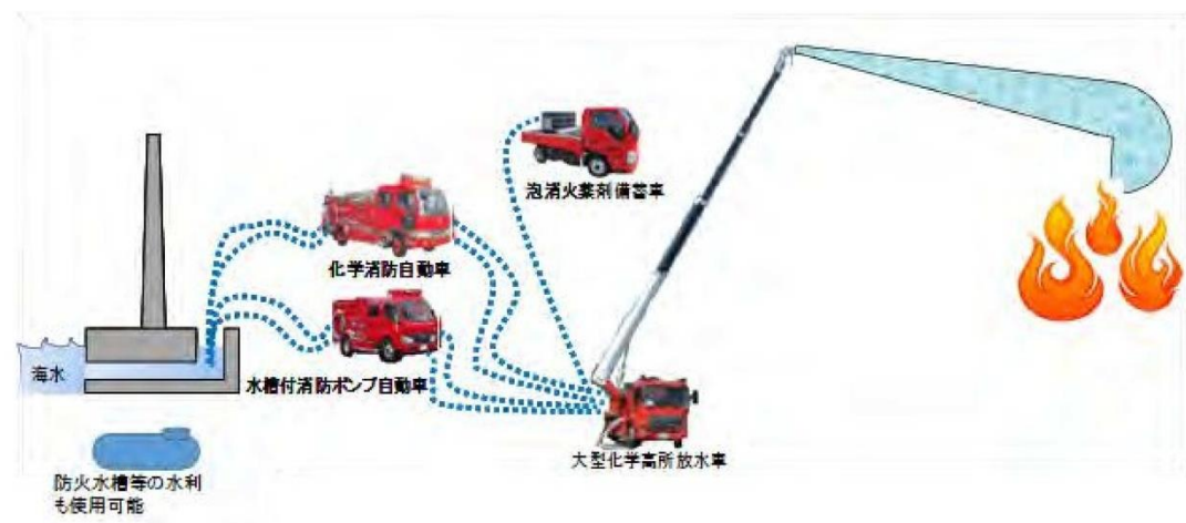
図 8-1 大型化学高所放水車による泡消火
