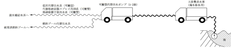
第3.13-5 図 重大事故等の収束に必要なとなる水の供給設備 系統概要図 (海を水源とした場合に用いる設備 (各系統の水源として使用))
