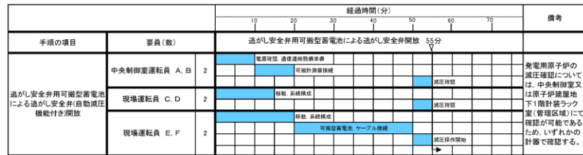
図 3.3-4 逃がし安全弁用可搬型蓄電池による逃がし安全弁(自動減圧機能付き)開放のタイムチャート*
