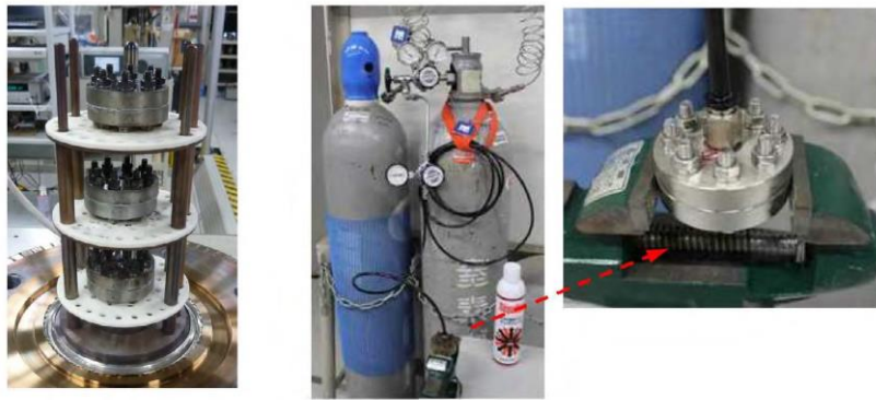
図3 蒸気用暴露 試験片設置状況
