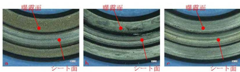
図7 試験後外観観察結果
