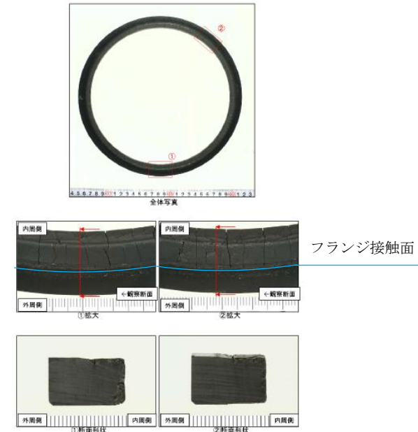
図5 200℃・168hr 試験後の試験体外観
