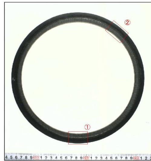
第3-8図 試験後の試験体外観 (200°C・168時間)
