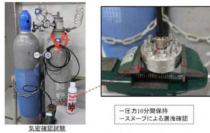
図 4-18 バックアップシール材の気密試験
