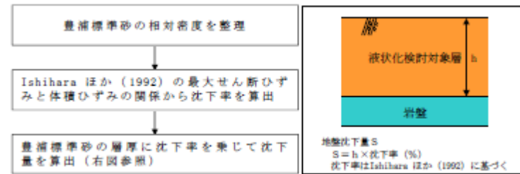
第6図 排水沈下量の算定フロー
