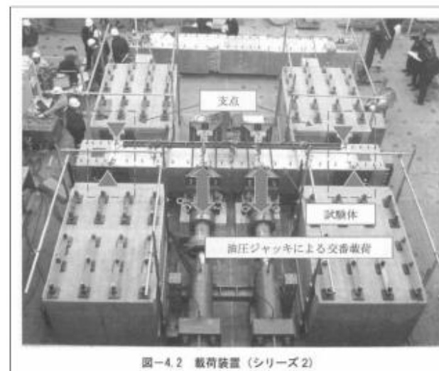
第3.3-3 図 せん断耐力向上性能試験の加力要領 (建設技術審査証明報告書より抜粋) (1/2)
