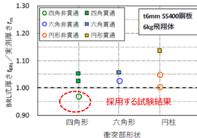
図 貫通試験の結果（電中研報告O19003） (BRL式による貫通限界厚さと実測板厚の比率に対する結果の違い)
