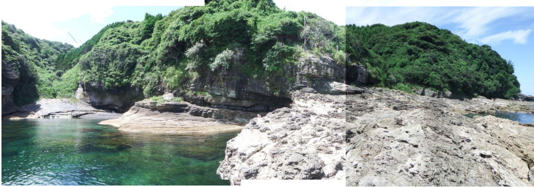
P4 海岸部には凝灰岩の連続露頭があり、層理面の走向傾斜は N57W 28N である。緩み構造の認められない C 4 級岩盤であり、地滑りの影響はないと考えられる。
