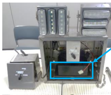
消火用非常照明 (壁掛け型) の設置例
