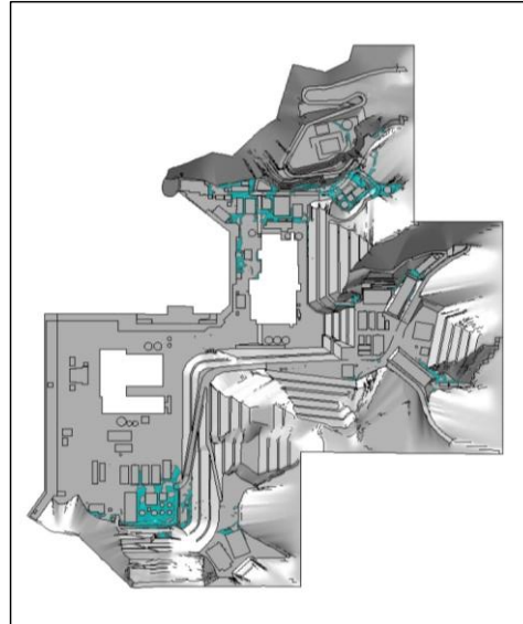
図 10-3-2 屋外タンクの溢水伝播挙動 (1/2)
