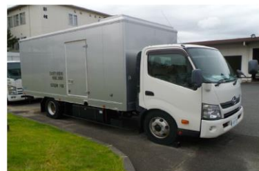
可搬型代替低圧電源車
