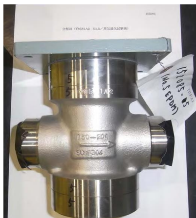
図1 T I P パージ弁外観写真
