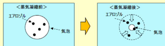
蒸気凝縮効果のイメージ図
