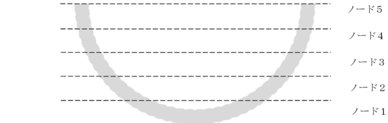
図1 原子炉压力容器下部ヘッドのノード分割 (概念図)
