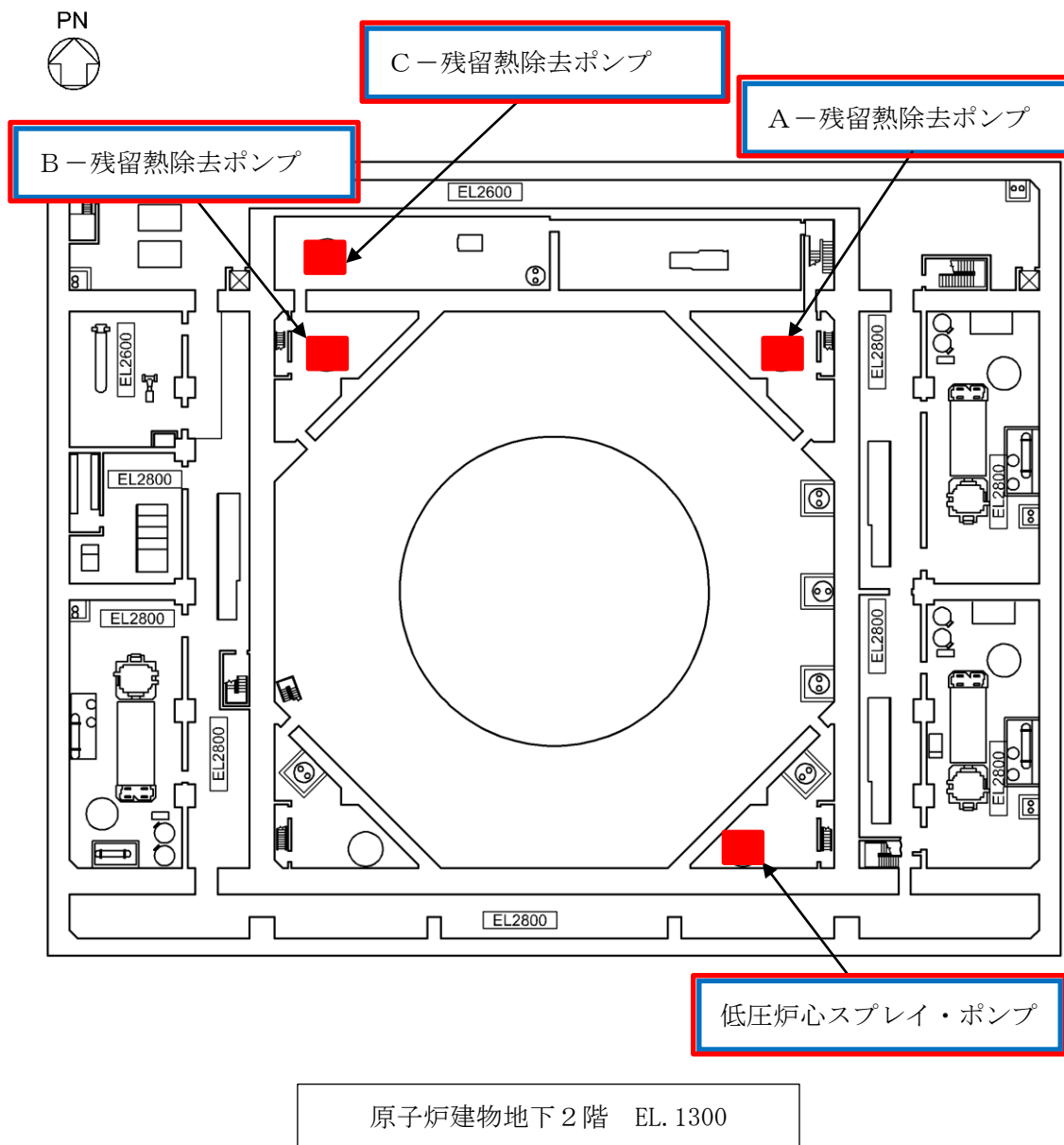
図3 残留熱除去ポンプおよび低圧炉心スプレイ・ポンプの配置図（原子炉建物地下2階）
