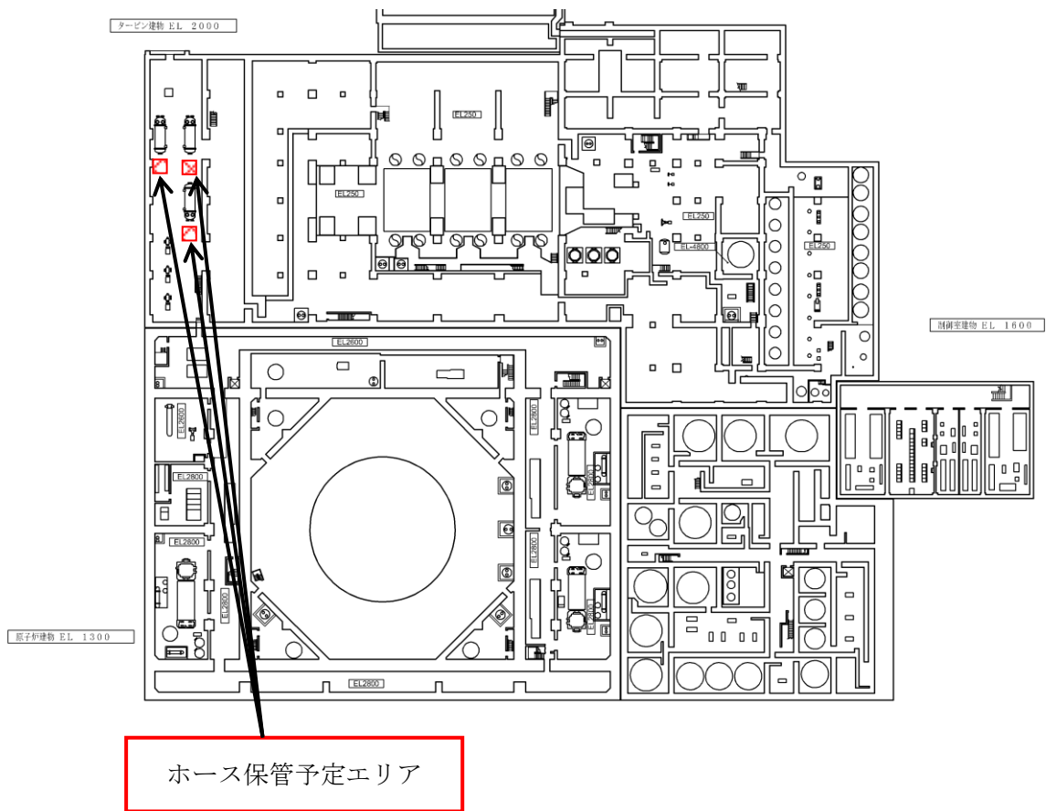
図2 可搬式窒素供給装置 屋内敷設用ホースの保管場所
