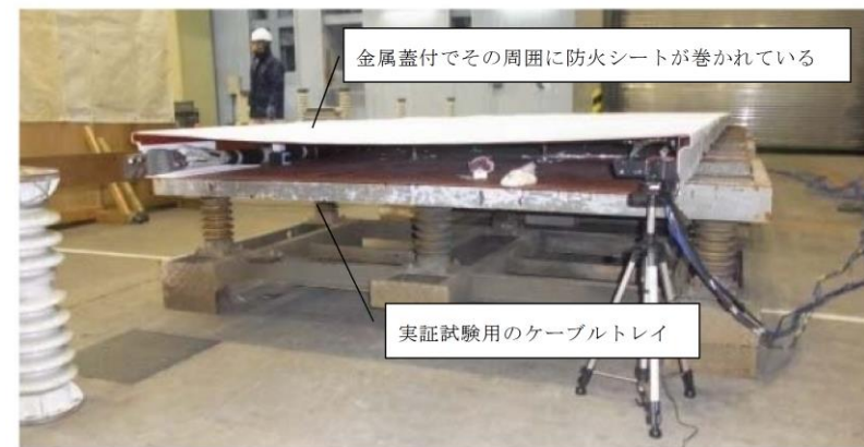
第 3 図 実証試験用のケーブルトレイ
