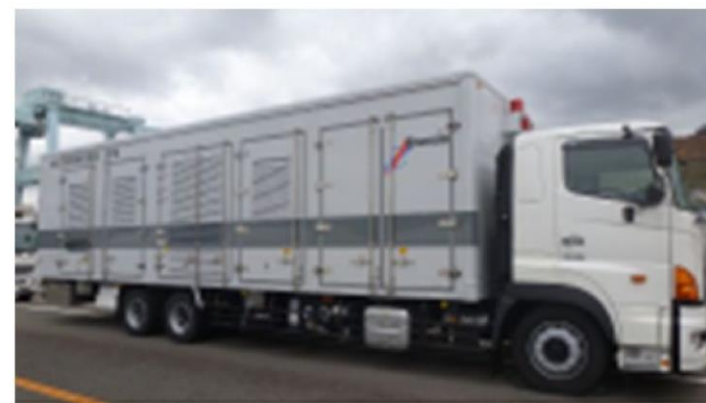
可搬式窒素供給装置
