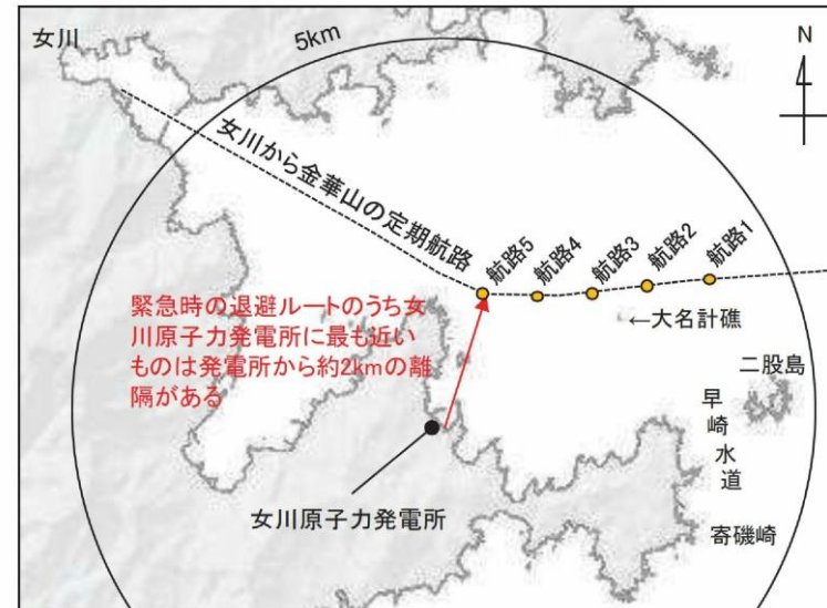
図2.5-40 津波警報時に想定される退避ルート及び軌跡解析の初期位置
