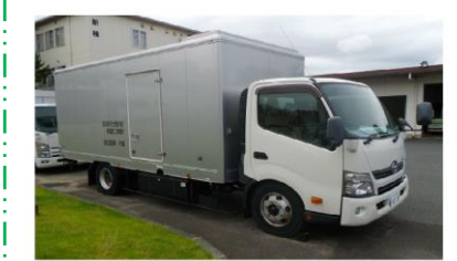
可搬型代替低圧電源車
