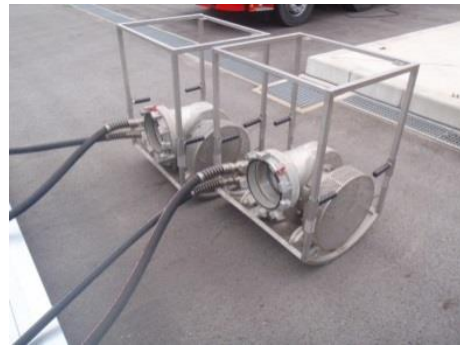
大型送水ポンプ車 水中ポンプ
