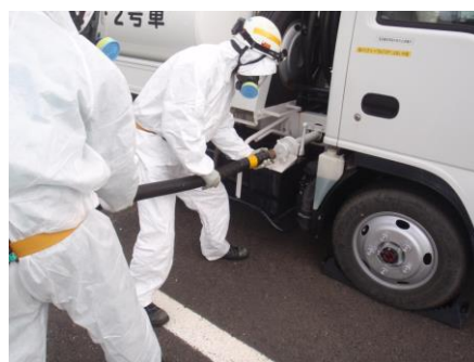
タンクローリへのホース接続
