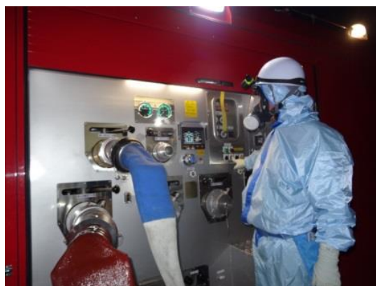
ポンプ起動操作（夜間）
