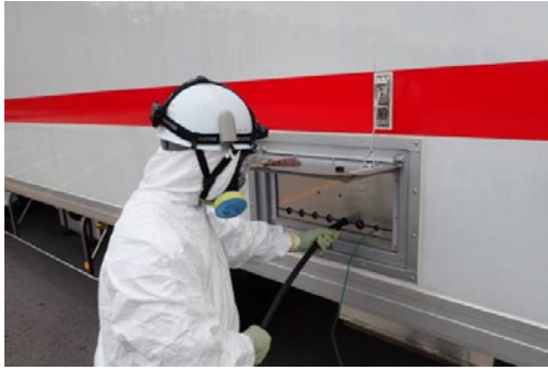
ケーブル接続作業
