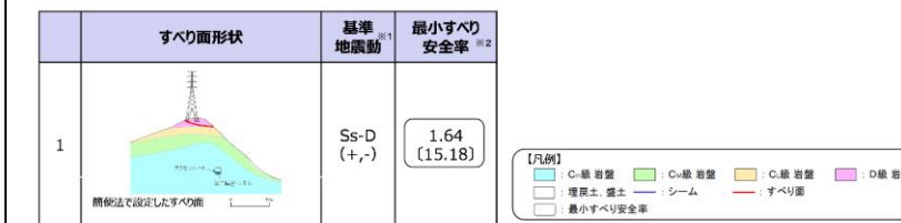
第 7.1-5 図 すべり安定性評価結果
