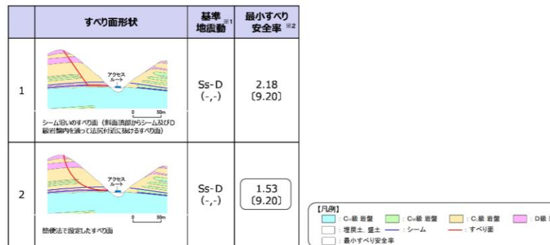
第 6.5-3 図 グループC (岩盤斜面, 法尻標高 T.P. +33~50m) のすべり安定性評価結果
