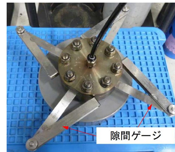
第 42 図 He 気密試験時開口模擬 (隙間ゲージ使用)
