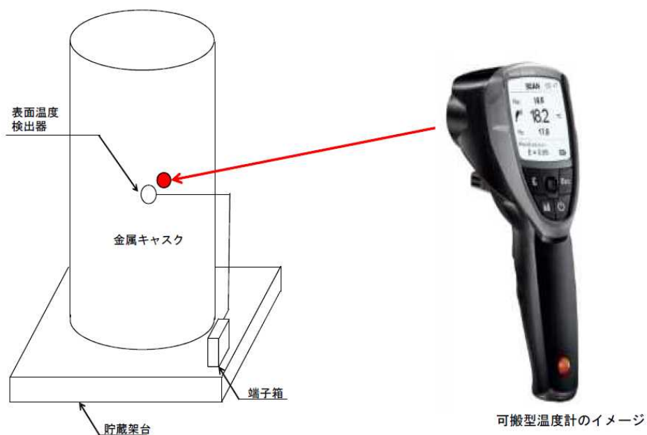
第3. 3-1図 金属キャスク表面温度の代替計測のイメージ
