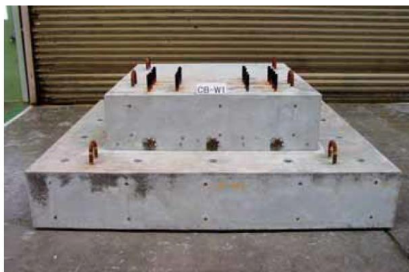
補足-4図 型枠脱型後の試験体
