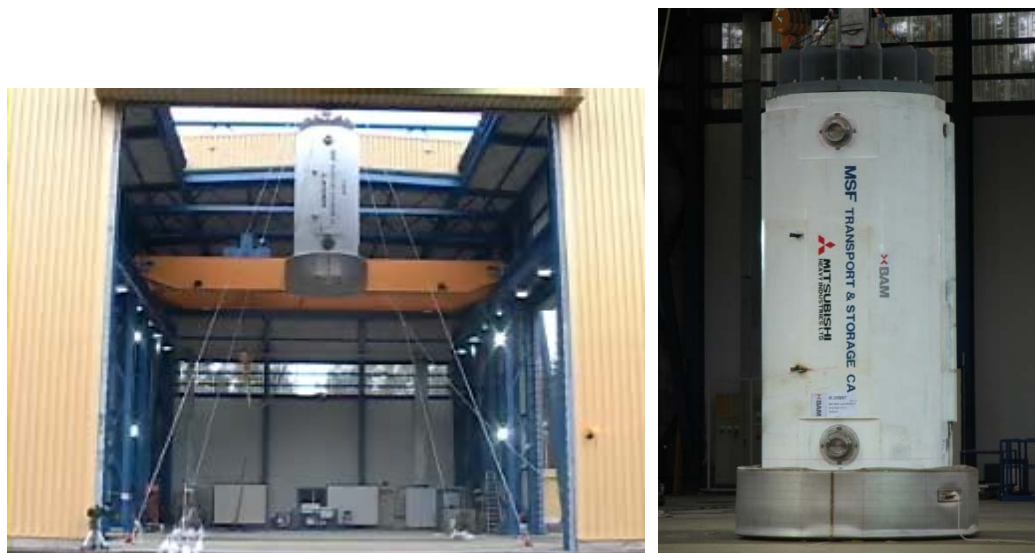
図 3 9.3m 頭部垂直落下試験時の試験体写真
