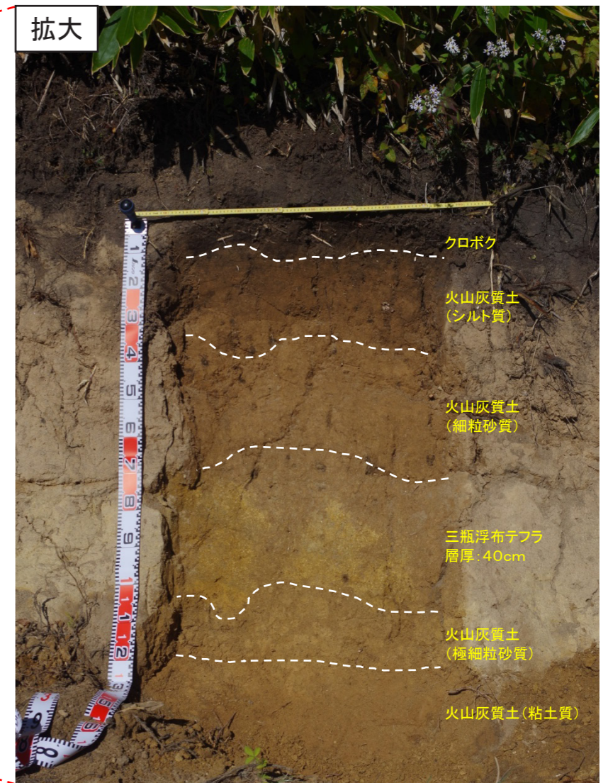
第7.2-11 図 三瓶浮布テフラに関する地質調査結果(岡山県北西部(新見市神郷))
