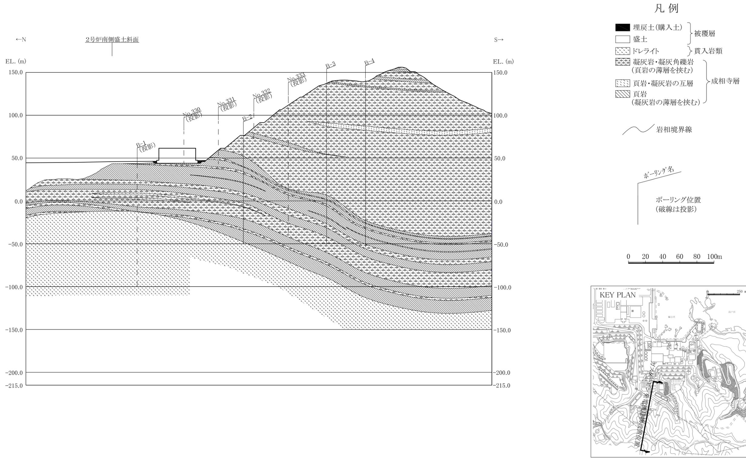
第3.4-8図 地質鉛直断面図 (ガスタービン発電機建物設置位置)
