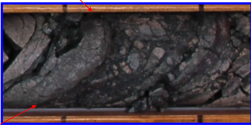
青枠部拡大 深度139.82mの軟弱粘土 0 5 cm
