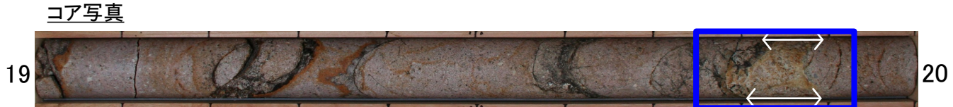
深度19.87mのフィルム状の細粒部
