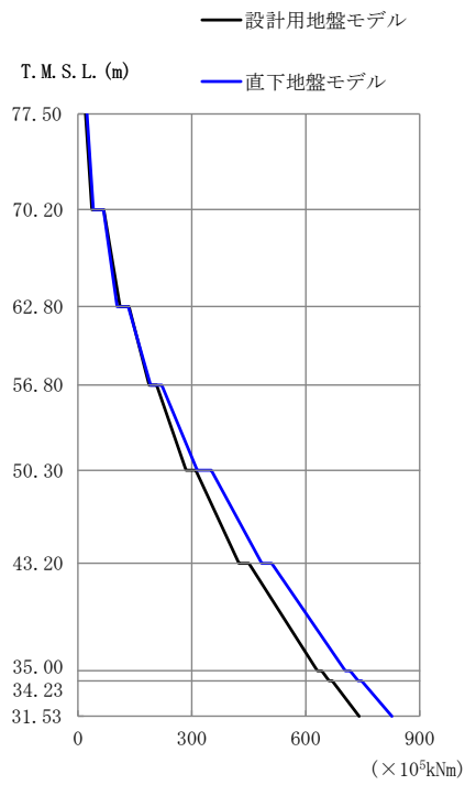
第 2.5.2.1-14 図 最大応答曲げモーメント (EW 方向 1.2×S s -C1(NSEW))
