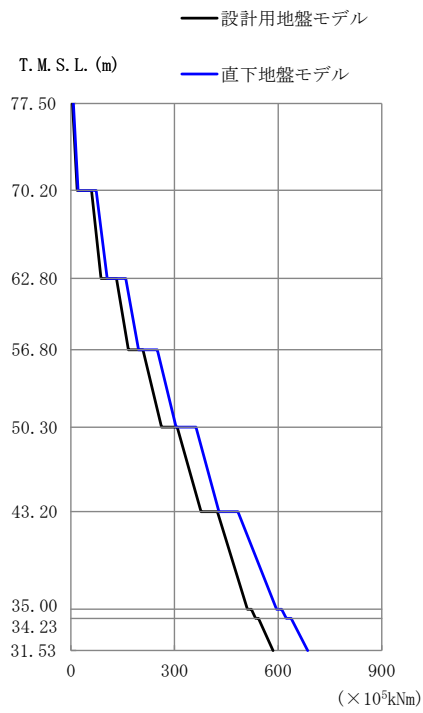
第 2.5.2.1-3 図 最大応答曲げモーメント (NS 方向 1.2×S s -A(H))
