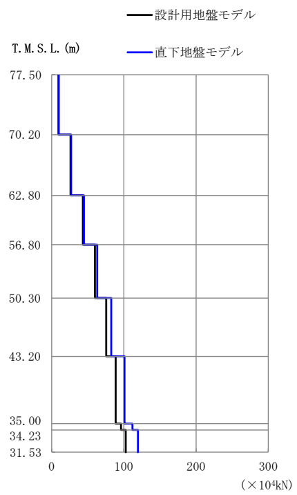
第 2.5.2.1-16 図 最大応答軸力 (鉛直方向 1.2×S s -C1(UD))
