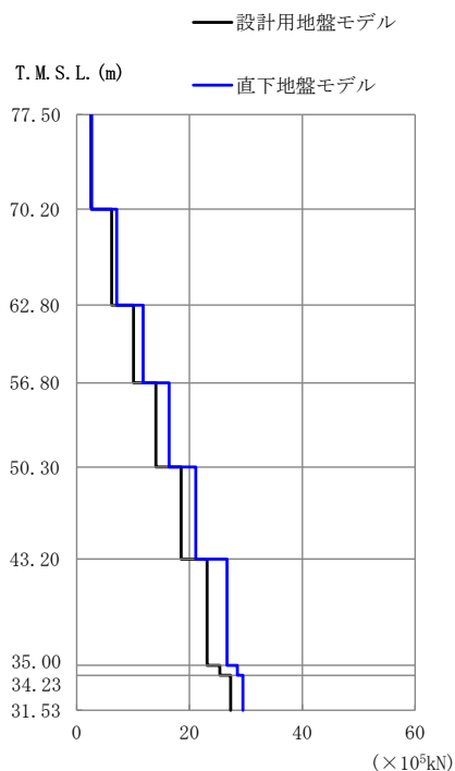
第 2.5.2.1-10 図 最大応答せん断力 (NS 方向 1.2×S s -C1(NSEW))
