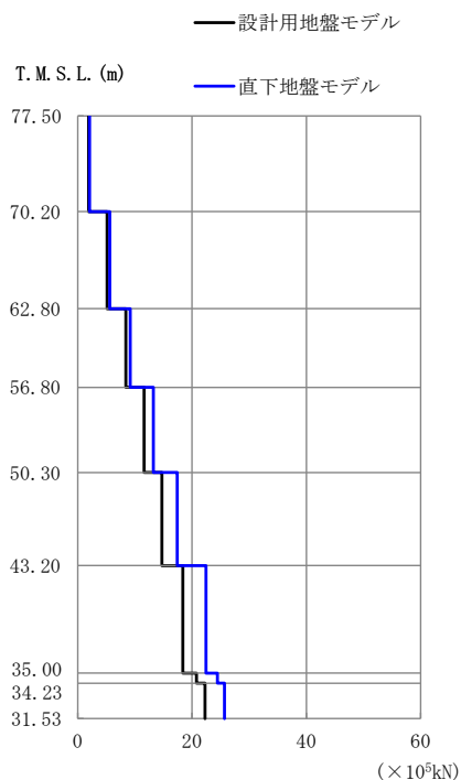
第 2.5.2.1-5 図 最大応答せん断力 (EW 方向 1.2×S S -A(H))
