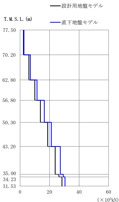
第 2.5.2.1-13 図 最大応答せん断力 (EW 方向 1.2×S s -C1(NSEW))
