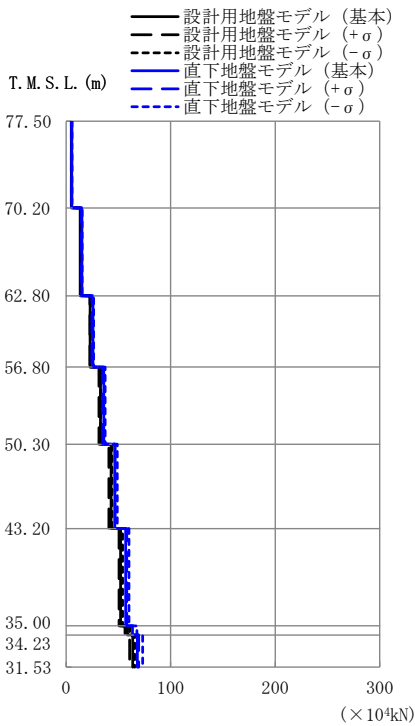
第 2.5.1.1-24 図 最大応答軸力 (鉛直方向 Sd-A(V))
