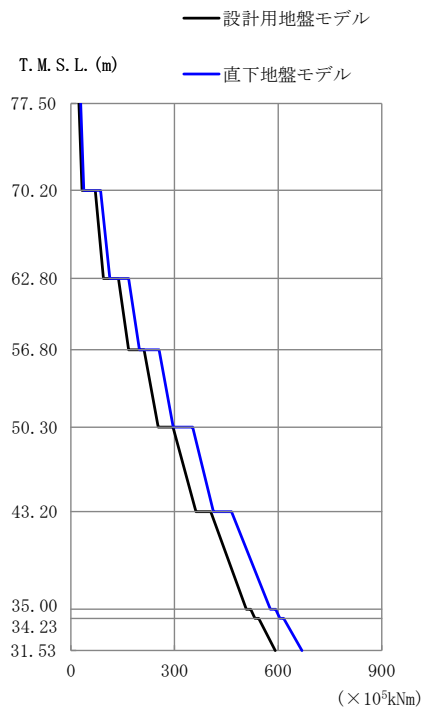
第 2.5.2.1-6 図 最大応答曲げモーメント (EW 方向 1.2×S s -A(H))
