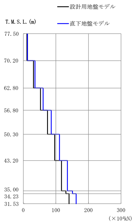
第 2.5.2.1-8 図 最大応答軸力 (鉛直方向 1.2×S S -A (V))
