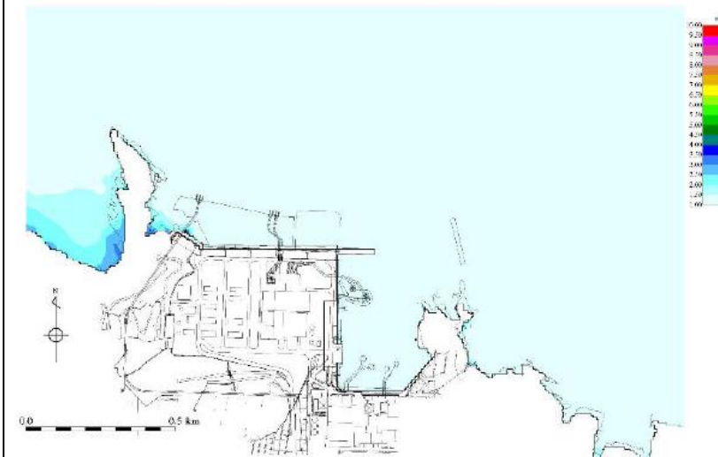
図4 (1) 海域活断層上昇側最大ケース (防波堤有り) 最高水位分布 (F-III断層+F-IV断層+F-V断層から想定される地震による津波)
