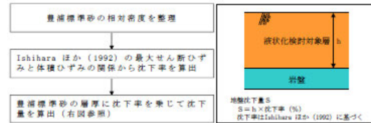
第6図 排水沈下量の算定フロー
