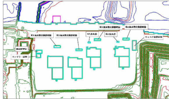
添付第 4-31 図(2) 地形モデル図〔西山層岩着施設を追加したケース〕
