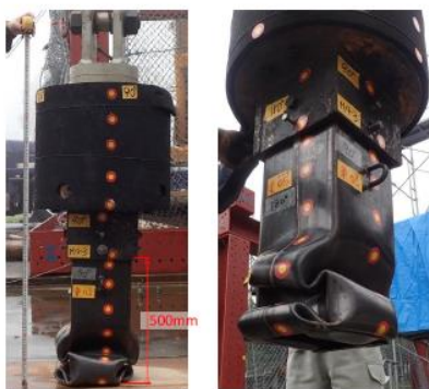
第8図 試験後の柔パイプ重錘の変形状況（参考文献(2)より）
