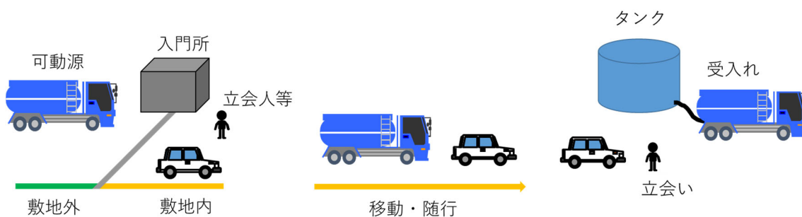
図2 立会いにより有毒ガスの発生を検出する手順のイメージ
