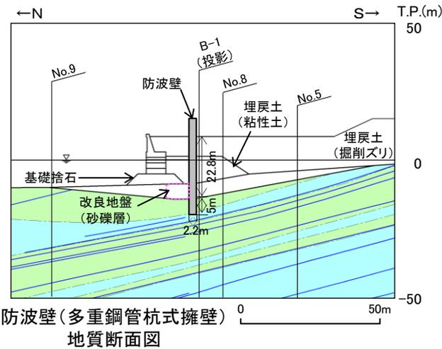
防波壁(多重鋼管杭式擁壁)地質断面図
