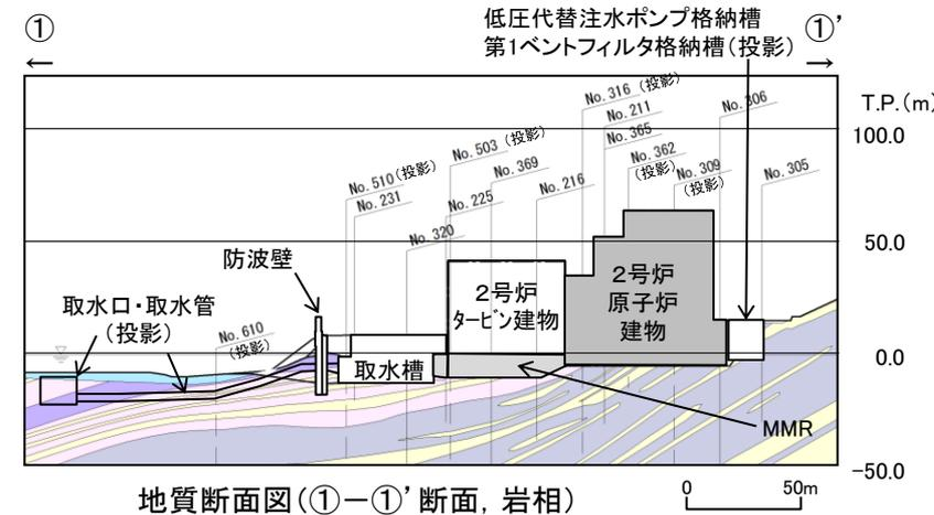
地質断面図(①-①'断面, 岩相)
