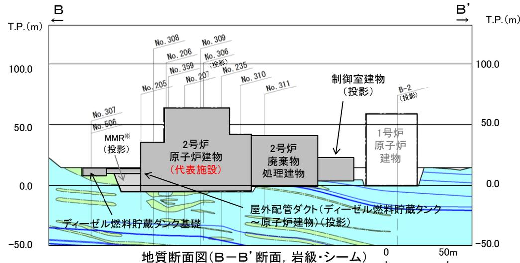
地質断面図(B-B'断面, 岩級・シーム)
