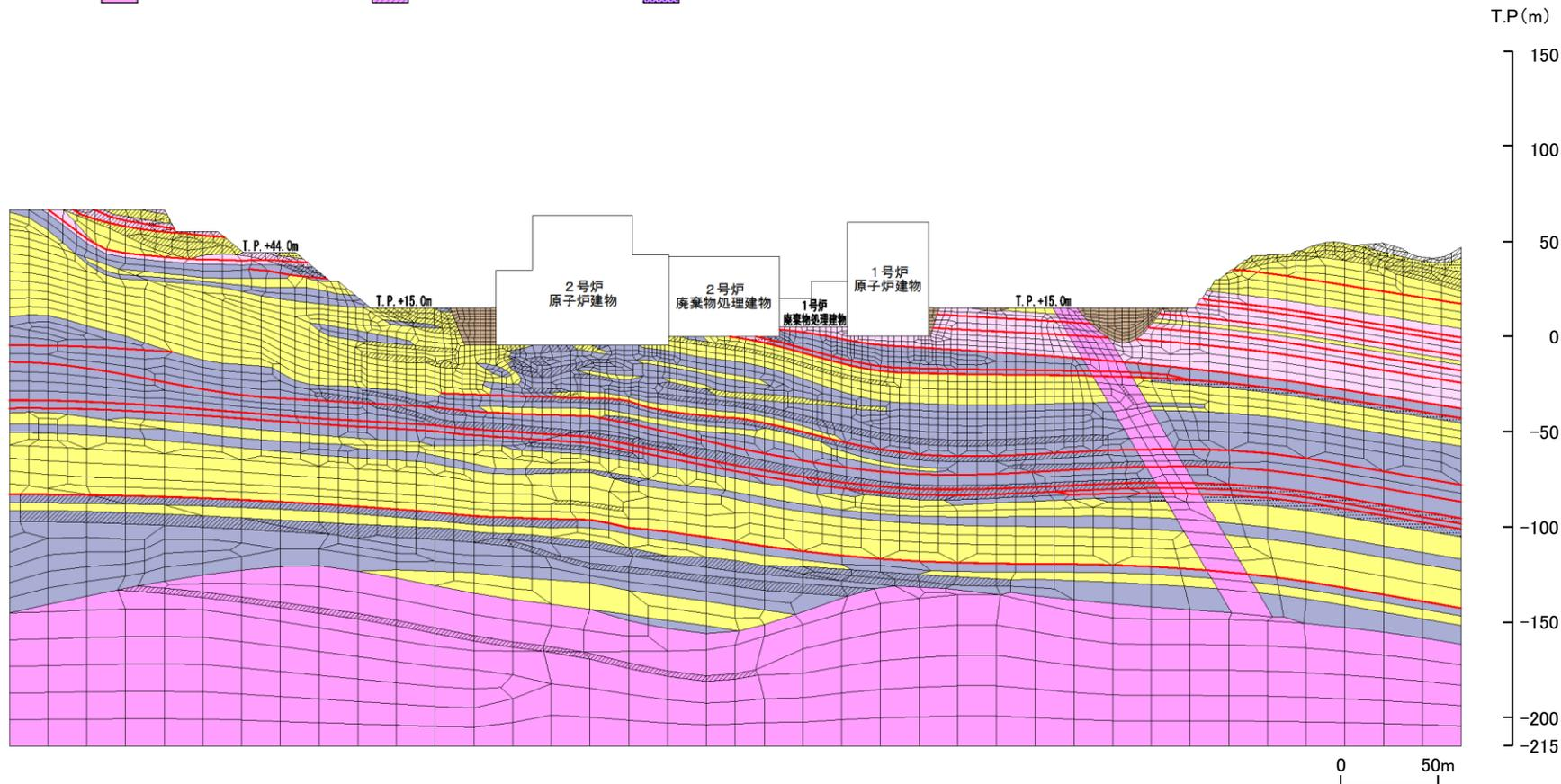
解析用岩盤分類図(ガスタービン発電機建物 ③-③'断面)
