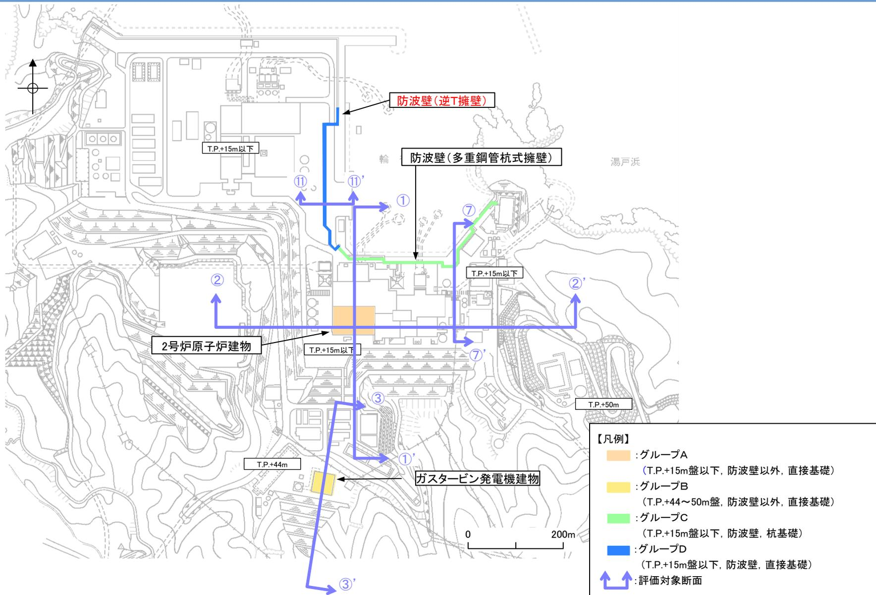
評価対象断面の選定結果
