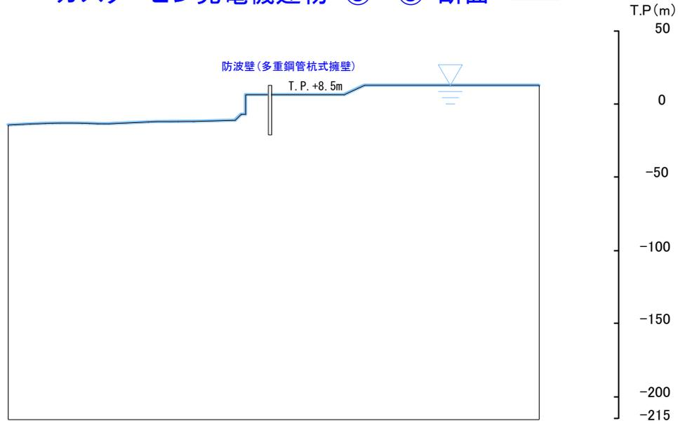
防波壁(多重鋼管杭式擁壁) ⑦-⑦' 断面
