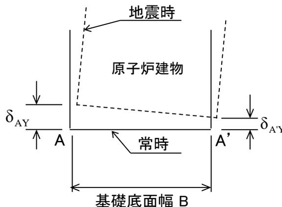
・原子炉建屋基礎底面の傾斜の最大値
