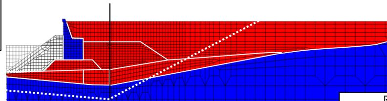
全応力解析の採用手法における液状化範囲の設定 (全時刻で同じ設定)
