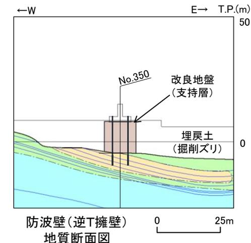
防波壁(逆T擁壁)地質断面図
