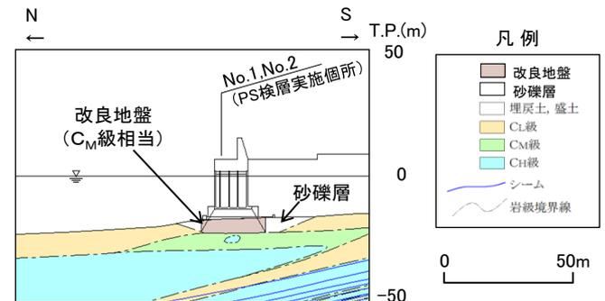
砂地盤改良部断面図(岩級・シーム)
