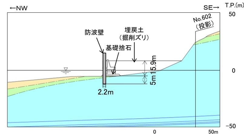
防波壁(多重鋼管杭式擁壁) I-3断面横断面図(岩級・シーム)
