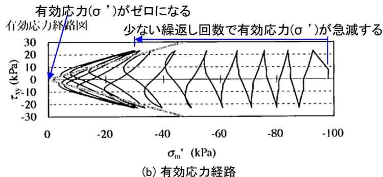
液状化試験の例(液状化する場合)
