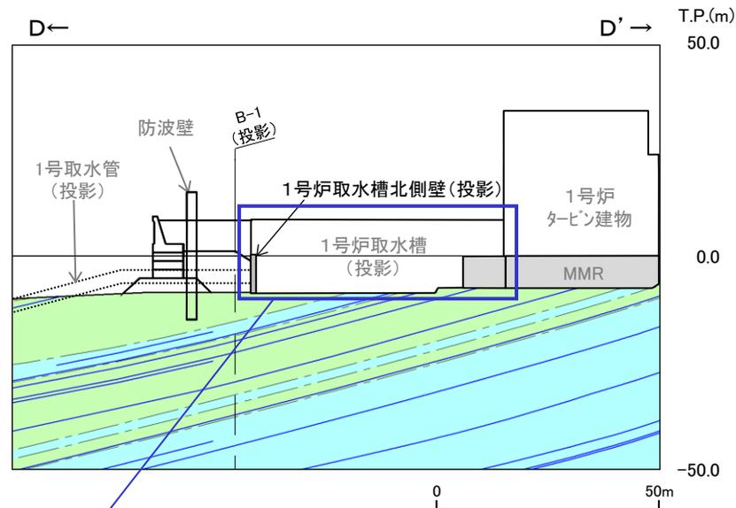
地質断面図(D-D'断面, 岩級・シーム)
