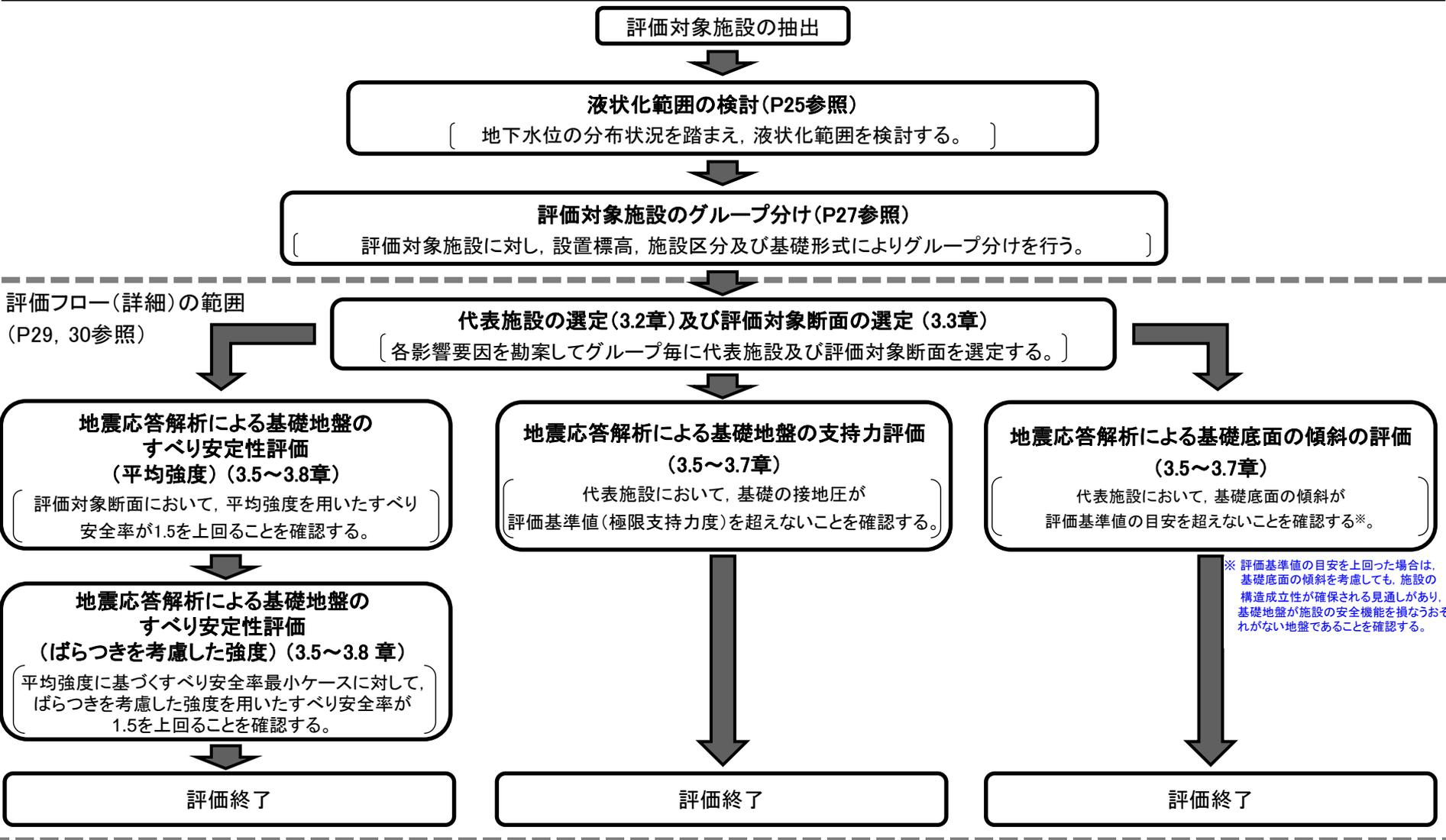
※ 評価基準値の目安を上回った場合は、基礎底面の傾斜を考慮しても、施設の構造成立性が確保される見通しがあり、基礎地盤が施設の安全機能を損なうおそれがない地盤であることを確認する。
