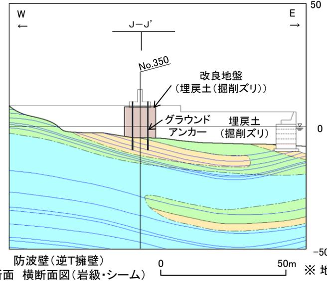
防波壁(逆T擁壁) J-3断面 横断面図(岩級・シーム)
