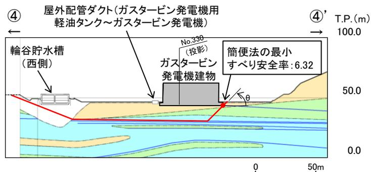
地質断面図(④-④'断面, 岩級・シーム)
