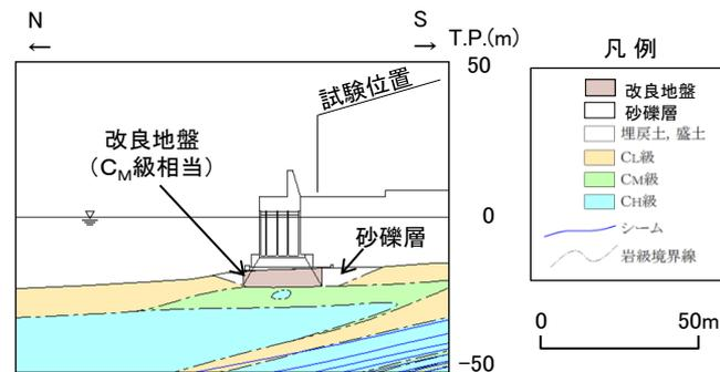
砂地盤改良部断面図(岩級・シーム)
