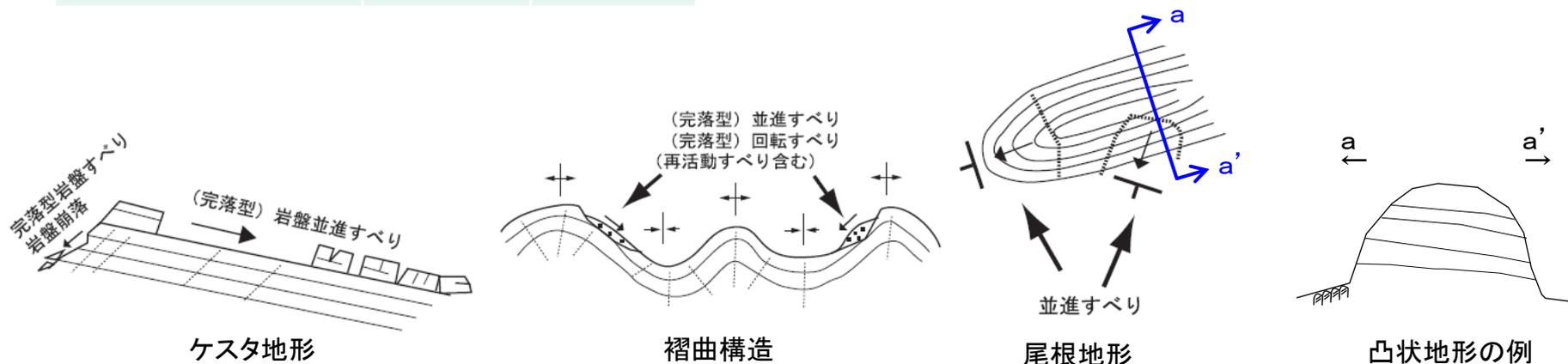
層理の発達する堆積岩分布域の斜面崩壊形状
