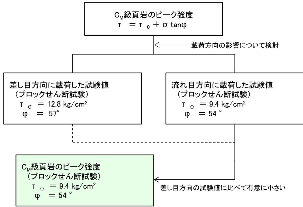
・流れ目方向に荷重した試験値は、差し目方向に荷重した試験値に比べて有意に小さい。
