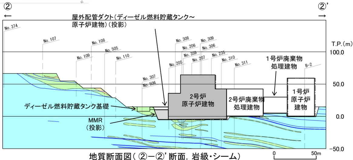
地質断面図(②-②'断面, 岩級・シーム)
