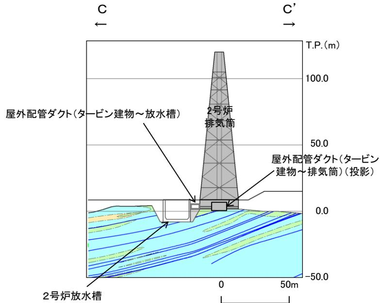
地質断面図(C-C'断面, 岩級・シーム)
