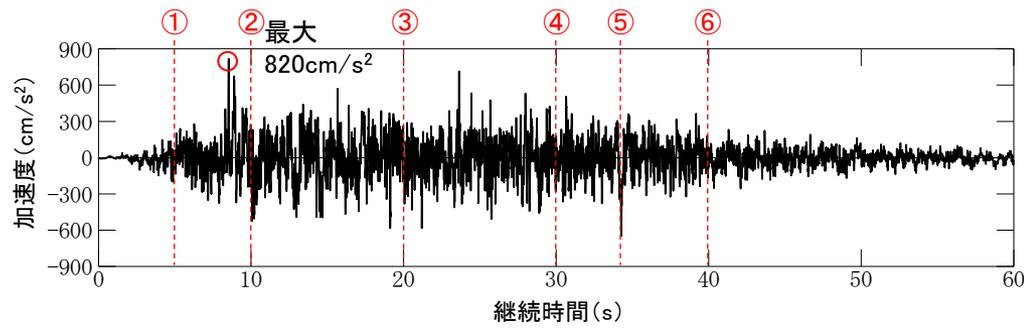
基準地震動S<sub>s</sub>-Dの時刻歴波形(水平)
