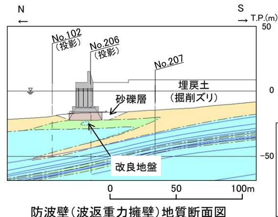
防波壁(波返重力擁壁)地質断面図
