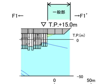
防波壁縦断面図(波返重力擁壁)
