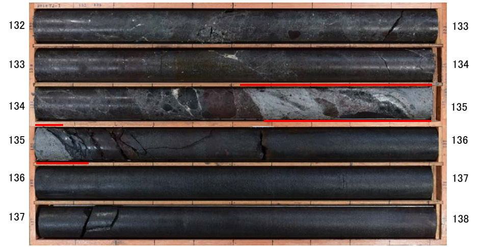
コア写真(深度132~138m) 破砕部
